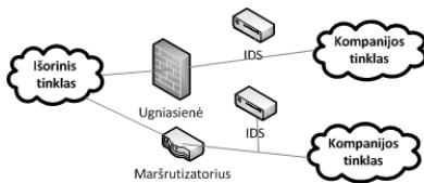
3 pav. IDS principinė schema.
