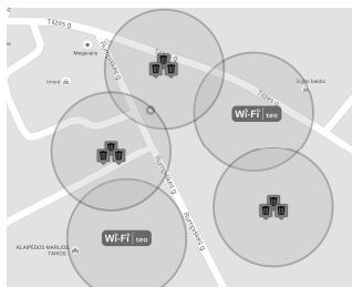
1 pav. TEO Wi-Fi maršrutizatorių bei konteinerių duomenų perdavimo modulių susijungimo žymės.
