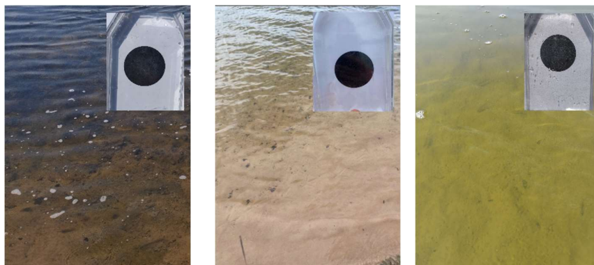
1 pav. Kašūčių ežero kranto ir pasemto vandens į permatomą butelį ant balto fono su juodu tašku nuotraukos padarytos 2023 06 01 (kairėje), 2023 08 22 (vidury) ir 2023 09 13 (dešinėje).
