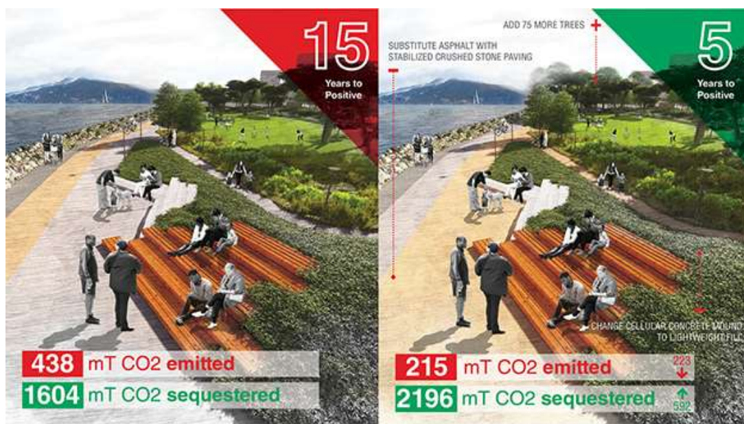
5 pav. Skirtingų kraštovaizdžio architektūros sprendimų įtaka jų nulinio poveikio pasiekimo laikui 7 .
